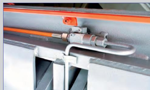
Hydraulisches Sicherheitsventil unter der Hubtischplattform
