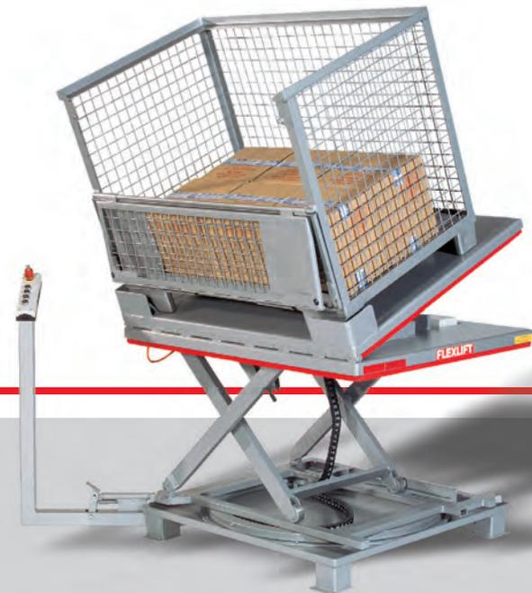
Bis ins kleinste Detail durchdacht: Das in der Plattform integrierte Hydraulikaggregat, die Kabelschleppführung, der superflache Drehkranz und die Bedienung über Stativ direkt am Tisch ergeben eine sehr kompakte, multifunktionale Einheit.
