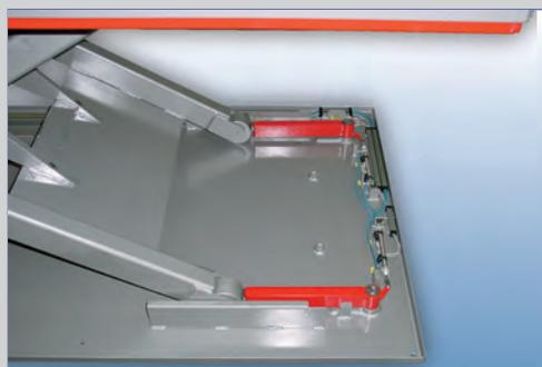
Flachform-Hubtisch der Baureihe FM mit pneumatischer Verriegelung für absolut stabile Positionierung.
