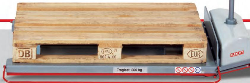
Bei einer Bauhöhe von nur 80 mm kann dieser Hubtisch mit jedem handelsüblichen Gabelhubwagen be- und entladen werden. Trotz dieser geringen Bauhöhe entspricht der Hubtisch allen Sicherheitsvorschriften der BG und der EN 1570.
