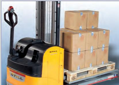
Durch die E-Plattform können die Stützgabeln des Hochhubwagens ebenerdig eingefahren werden.
