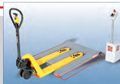
Für den Nutzer bedeutet dies, dass er Paletten und Gitterboxen mit bis zu 2.000 kg Gewicht einfach und bequem auf dem Hubtisch absetzen und wieder abnehmen kann.
